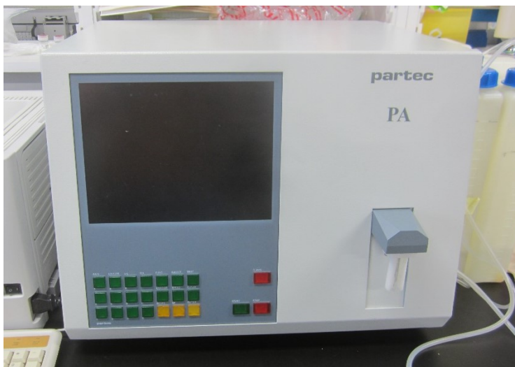
第1図 フローサイトメーター 染色したDNAの蛍光強度を測定することで倍数性を判定することができる
