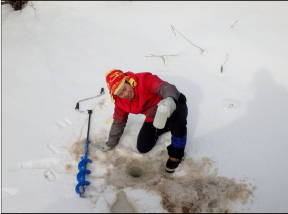
図 2 B1 定点における冬季採水の風景。ワカサギ釣り用のドリルで氷に穴をあけ、そこから河川水を採集した。
